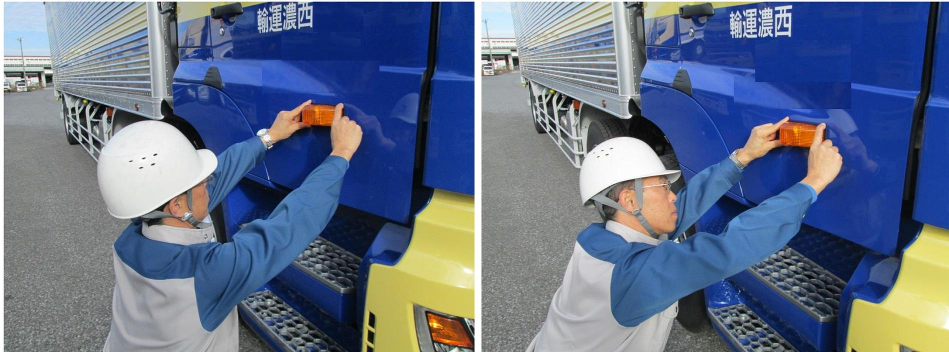
●ドアウインカーレンズの確認範囲を両手で押さえ点検する
