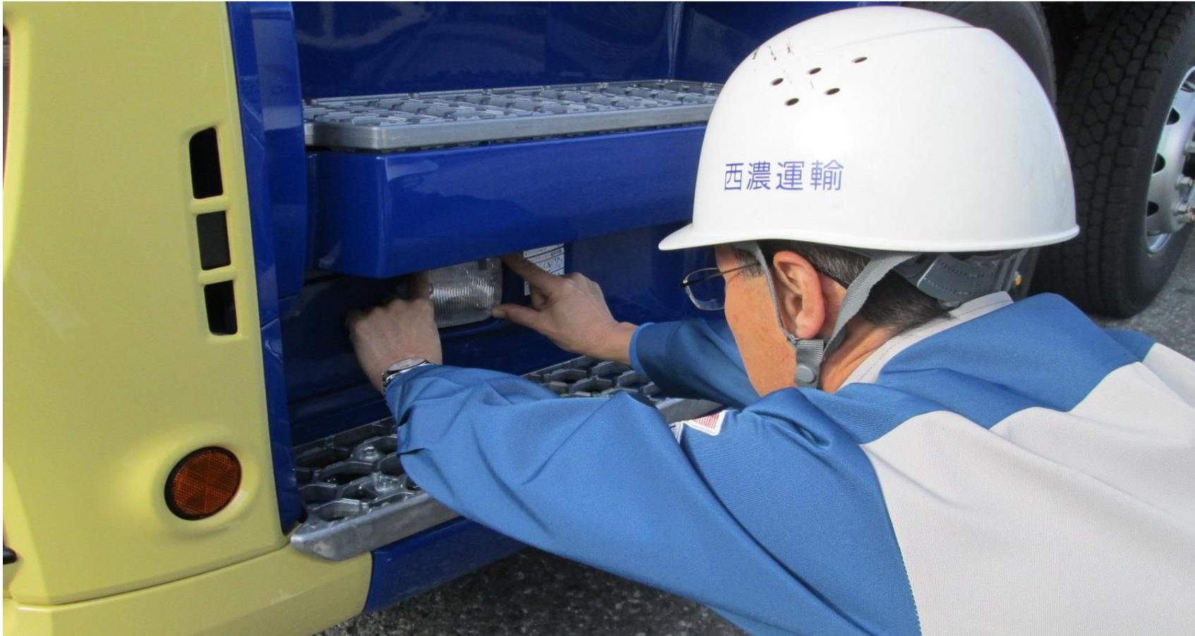
●コーナリングランプの確認範囲を両手で押さえ点検する
