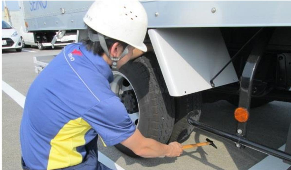
トレッド面に手を添えて振動も併せて点検
