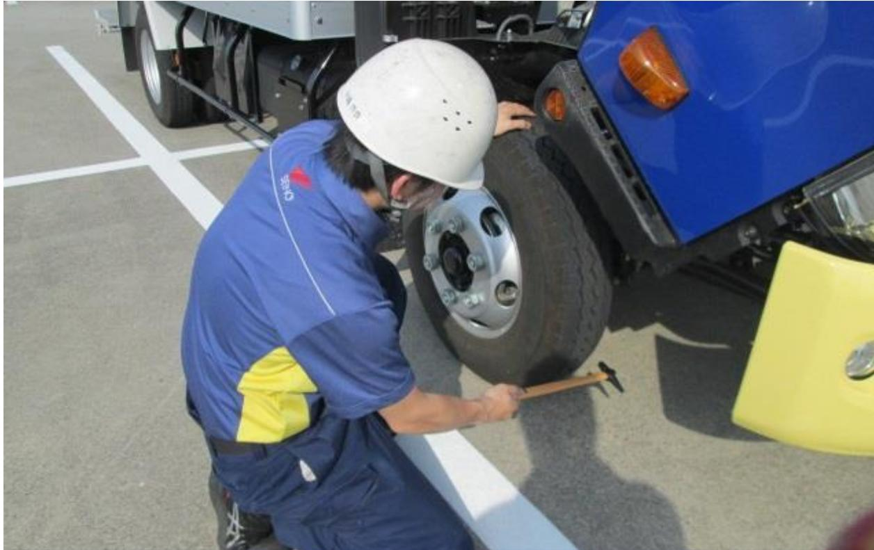
トレッド面に手を添えて振動も併せて確認
